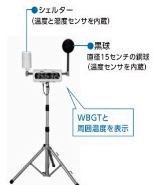
図2 WBGT測定装置 (リアルタイムでWBGTと周囲温度が表示される)
